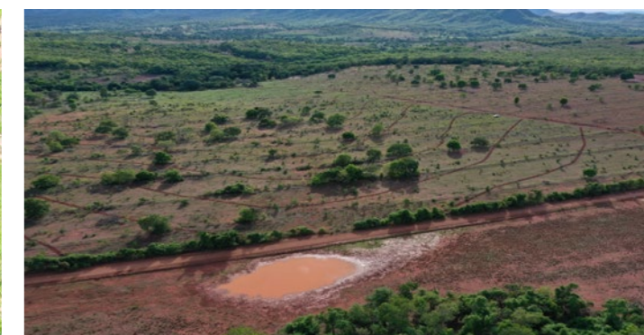
Contour lines for terraces, Faz. San Jose Locality: Córrego Fundo Basin, Barra do Garças, Mato Grosso
